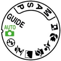
Über das Funktionswahrad auf der Oberseite der D3200 können Sie durch Drehen alle verfügbaren Modi der Kamera aktivieren. Die Motivprogramme, der **Guide**-Modus, die Halbautomatiken **P**, **S**, **A** und der manuelle Modus **M** werden Ihnen noch an anderer Stelle im Buch begegnen. Der vollautomatische Modus **AUTO** ist zusätzlich grün eingefärbt.
